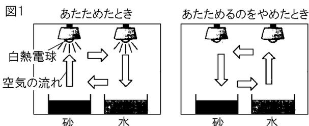
図1は、その結果を模式的に示したもので、矢印は白熱電球を点灯してあたためたときと、白熱電球を消灯してあたためるのをやめたときの空気の流れを表したものである。これについて、後の各問いに答えよ。
