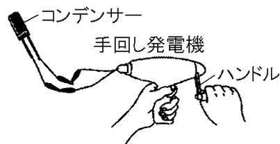
この実験において、コンデンサーには①(力学的／電気)エネルギーが蓄えられており、豆電球や LED 豆電球では①エネルギーが②(電気／光)エネルギーに変換されている。LED 豆電球のほうが点灯する時間が長かったことから、豆電球と LED 豆電球では、③(LED 豆電球／豆電球)のほうが変換効率が高いと考えられる。
