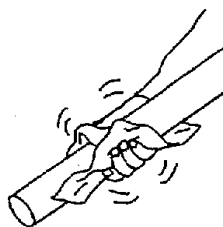
③ アルコールでふいた塩化ビニルの管をティッシュペーパーでよく摩擦する。
