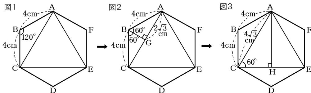
図1のように、頂点A, C, Eを結ぶ。 $\triangle ABC$ ,  $\triangle CDE$ ,  $\triangle EFA$ は、すべて、2辺が4cmでその間の角が $120^\circ$ の合同な三角形になる。したがって、 $\triangle ACE$ は正三角形になる。正三角形の面積は1辺の長さがわかれば計算できる。
