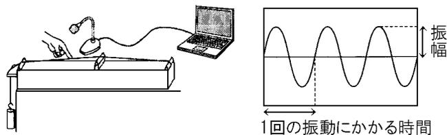
れて、モノコードの音が小さくなった。音が小さくなったとき、1回の振動にかかる時間は①(長くなり/短くなり/変化せず), 振幅は②(大きくなる/小さくなる/変化しない)。また、図1の木片を移動させて弦をはじいたとき、モノコードの音が高くなった。音が高くなったとき、振動数は③(大きくなる/小さくなる/変化しない)。①～③の( )の中からそれぞれ最も適当なものを1つずつ選べ。
