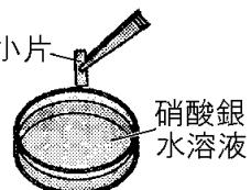
結果 : 実験 I では、銅の小片の表面には、変化はなかつた。実験 II では、銅の小片の表面に、銀色の物質が現れ、水溶液が青色に変化した。
