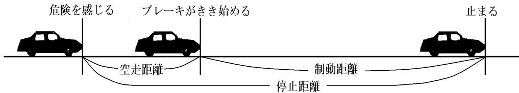
空走距離は、自動車の速さに比例し、制動距離は、自動車の速さの 2 乗に比例する。今、時速 30km で走る自動車の制動距離が 8m であった。この自動車の速さを時速  $x$  km、そのときの制動距離を  $y$  m として、次の各問いに答えよ。
