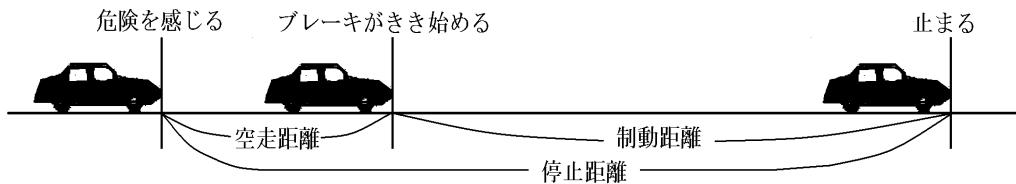
空走距離は、自動車の速さに比例し、制動距離は、自動車の速さの 2 乗に比例する。今、
