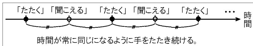
連続して手をたたき続けている途中、ある「たたく」から 10 回後の「たたく」までの時間をストップウォッチで測定したところ、測定結果は 10.4 秒であった。ただし、測定開始の「たたく」は 0 回として数えた。この実験から求められる音の速さは何 m/s か。小数第 1 位を四捨五入して整数で答えよ。
