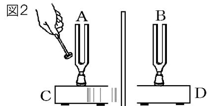
図 1 のように、おんさ A をたたくと、A の振動が C の中の空気を振動させ、その空気の振動が D の中の空気に伝わり、B のおんさを振動させ、B の音さが①(鳴る／鳴らない)。その後、A のおんさを手でおさえて A の振動を止めると、A からは音がでなくなるが、B はそのまま振動を続け、音が鳴り続ける。次に、図 2 のように、A と B の間に板を入れて A をたたくと、C の中の空気の振動が D に伝わりにくくなる。そのため、B の音は図 1 の場合と比べて②(大きく／小さく／同じに)なる。
