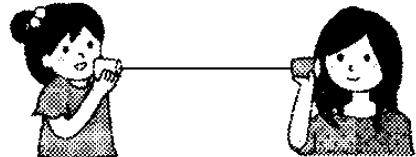
声が紙コップの中にある( ① )を振動させ、それが紙コップの底を振動させて、さらに( ② )の振動となって相手に伝わる。
