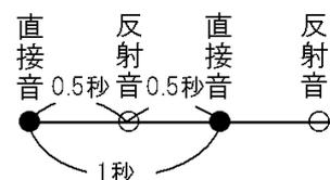
したがって、(音の伝わる速さ) = (距離 m) ÷ (時間 s) =  $174(\text{m}) \div 0.5(\text{s}) = 348(\text{m/s})$  となる。
