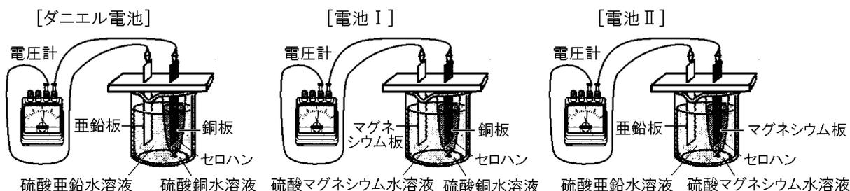
田中：先生。ダニエル電池では、亜鉛が電子を失って亜鉛イオンになって溶け出したとき、その電子が移動することによって電流が取り出せました。だから、電池の電圧の大きさは、電池に用いる金属の( ① )が関係していると思います。
