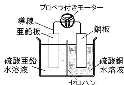
セロハン膜がとり除かれ2つの水溶液が混ざったことで、( )反応が起こり、導線中の電子の移動がほとんどなくなったためと考えられる。
