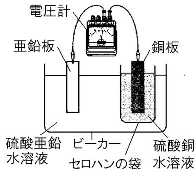
図の装置の5%硫酸亜鉛水溶液と亜鉛板を、5%硫酸マグネシウム水溶液とマグネシウム板に変えたところ、電圧計の針が( ① )ふれた。また、図の装置の5%硫酸銅水溶液と銅板を、5%硫酸マグネシウム水溶液とマグネシウム板に変えたところ、電圧計の針が( ② )ふれた。
