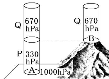
右図の A 地点で密閉された菓子のふくろを B の山頂までもって上がると、菓子のふくろはふくらむ。A 地点の気圧は 1000hPa であるので菓子のふくろ内の気圧も 1000hPa である。これに対し、B 地点の気圧は 670hPa なので、ふくろの外の気圧がふくろの中の気圧よりも小さくなって、ふくろの中の空気が膨張するためである。
