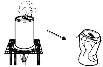
火を消すと、熱されて空きかんの中に広がっていた気体の水蒸気が、冷えて液体の水にもどる。すると、空きかんの中の気体の
