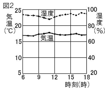
図1は①(晴れ/雨)の日の記録である。気温は夜明け前に最低になり、午後2時ごろ最高になっている。湿度は気温と反対に動き、夜明け前に高く、気温の上昇とともに低くなっている。図2は②(晴れ/雨)の日の記録である。このときも、湿度は気温と反対に動くが、気温の変化は少なく、湿度はつねに高いままで変化が少ない。
