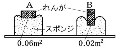
れんががスポンジをおす力は A と B は同じであるが、れんがとスポンジの接する面積は B が A の 3 分の 1 なので、接する面積  $1\text{m}^2$  あたりの力の大きさは、B は A の ( ① ) 倍になる。そのため、B の場合スポンジのへこみ方は A より大きくなる。接する面積  $1\text{m}^2$  あたりの力の大きさを ( ② ) という。
