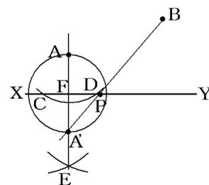
直線  $A'B$  と直線  $XY$  の交点が求める点  $P$  である。
