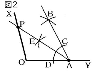
まず、Oを中心とする半径OAの円と、Aを中心とする半径OAの円をかき、その交点をBとする。次に、Aを中心とする円をかき、図のように点CとDをとる。さらに、C、Dをそれぞれ中心とする同じ半径の円を描き、2つの円の交点をEとする。直線AEとOXの交点が点Pである。
