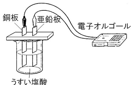
電池になるための条件の第一は、水溶液が電解質であることである。うすい塩酸、うすい硫酸、レモンの汁、食塩水などの電解質の場合、電流が流れる。
