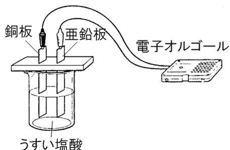
条件の第二は、電極に( ④ )なる種類の金属を使うことである。亜鉛板と銅板の場合は電流が流れるが、亜鉛板と亜鉛板の場合には電流は⑤(流れる／流れない)。また、亜鉛板とスライドガラスの場合も電流は⑥(流れる／流れない)。
