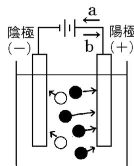
陰極(-)に引きつけられる○は銅イオン( $\text{Cu}^{2+}$ )で一極から電子2個をもらって銅原子( $\text{Cu}$ )となって、電極に付着する。
